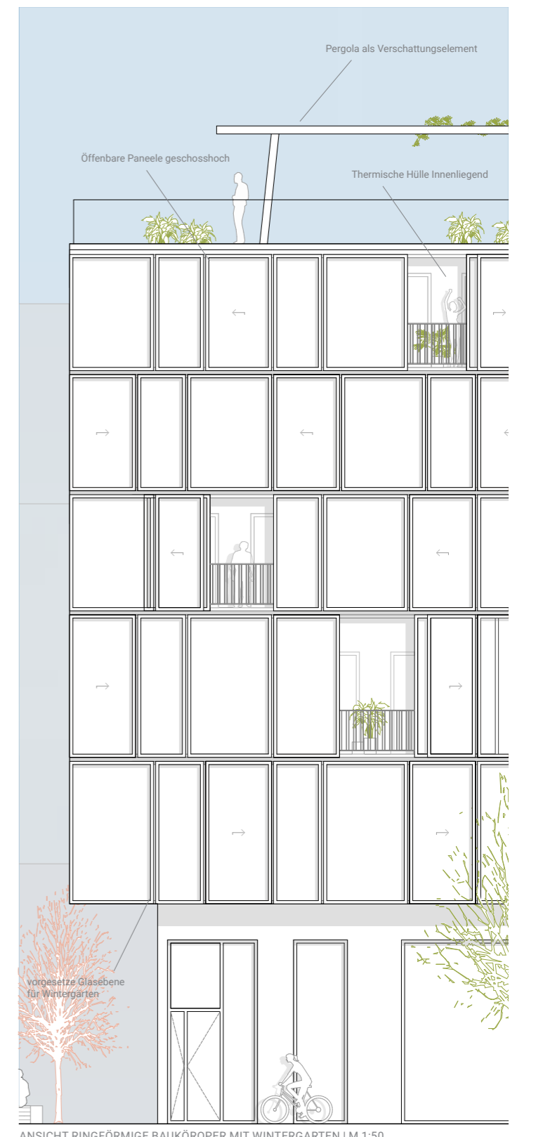
ANSICHT RINGFÖRMIGE BAUKÖRPER MIT WINTERGARTEN | M 1:50
